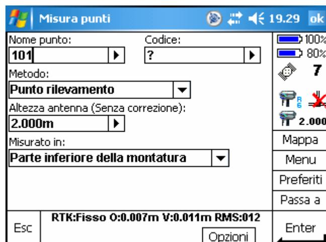
A questo punto sarà sufficiente cliccare su **Misurare** (oppure Enter sulla tastiera) e se lo stile di rilievo è impostato con la registrazione automatica del punto, il programma provvederà alla memorizzazione della misura e vi proporrà il nuovo punto da rilevare.
