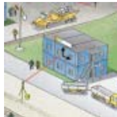
MISURE DI FACCIATE Consente misure di facciate di edifici senza l'ausilio del prisma. Misure di altezze di ponti, sopraelevate e segnaletica stradale.
