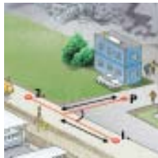
STAZIONE ED OFFSET Il posizionamento di un fabbricato all'interno di una griglia di progetto con relativo controllo.
